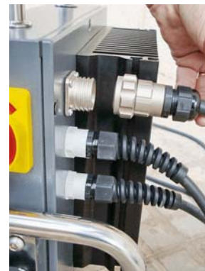
Figura 11b: Cable de alimentación desconectado
